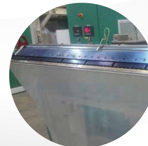
Filière PET KUHNE à canal en T avec decking interne
