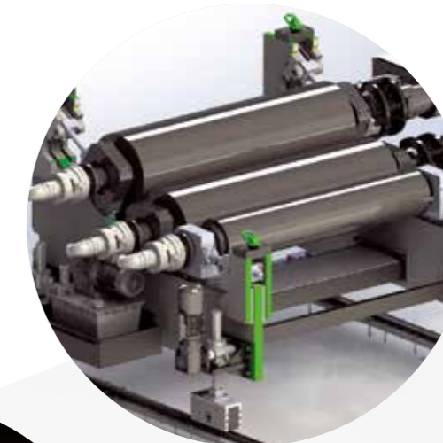
Calandre horizontale de KUHNE pour le PET avec réglage hydraulique des cylindres
