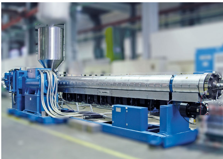
7,5 m breite Anlage zur Herstellung von Geomembranfolien
