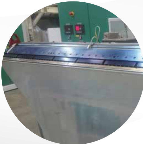
KUHNE PET T-Kanaldüse mit internem Deckling
